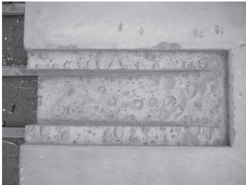
図-3 模擬試験体下面の気泡滞留状況
